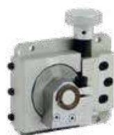
Élément de rotation JC-MR 60, axe de rotation: 360 ° chargeable jusqu'à 5 kg
