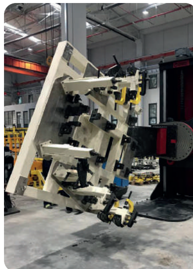
Installation chez un client dans le 74 d'un Positionneur à Colonne 3 axes capacité 5 tonnes
