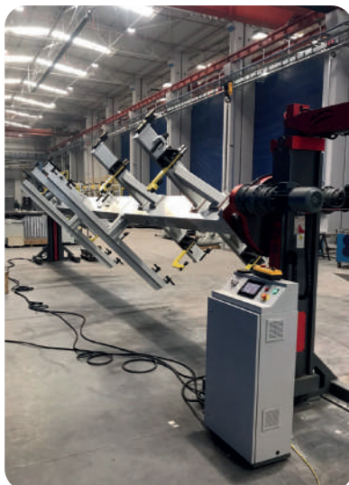
Installation chez un client dans le 74 d'un Positionneur Double colonne fixe capacité 3 tonnes Distance de travail 8 mètres
