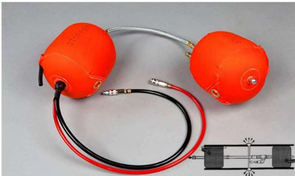
Pour l'inertage des conduites de Ø50 à Ø1500mm (au-delà sur commande). Ces ballons, parfaitement cylindriques, sont équipés d'une housse ignifugée et d'une vessie en latex
