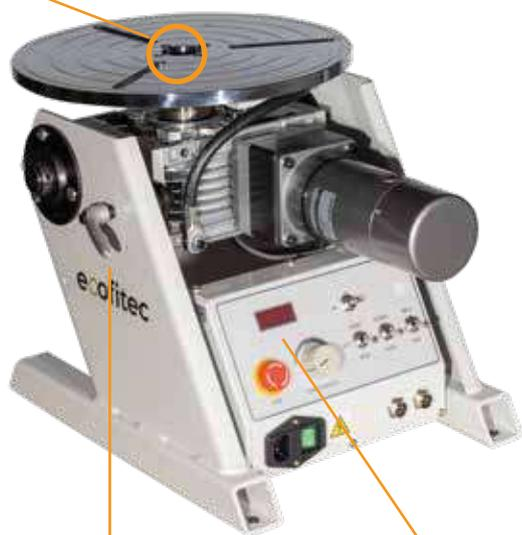
Inclinaison manuelle de la table par poignée de verrouillage
