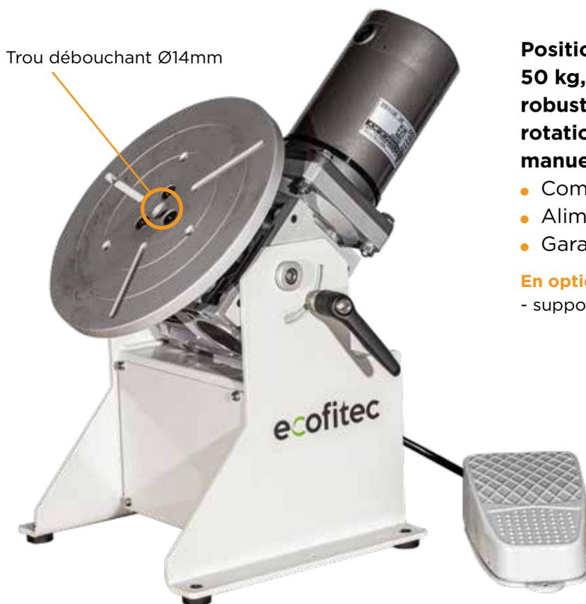
**Positionneur de soudage capacité 50 kg, composé d'une structure robuste avec vitesse de rotation réglable, inclinaison manuelle de la table par poignée.**
