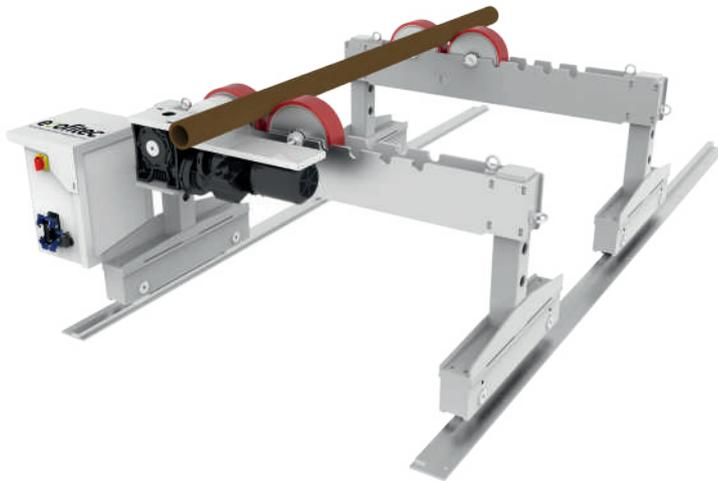
Les vireurs EFVE permettent le positionnement de viroles avec un ajustement de la hauteur de l'axe de rotation sur 3 niveaux.
