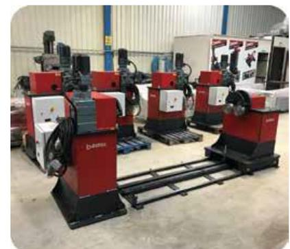
Ce positionneur permet la rotation de châssis et autres constructions métalliques avec axe de rotation variable en hauteur.
