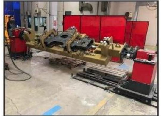
**Ce positionneur permet la rotation de châssis et autres constructions métalliques**
