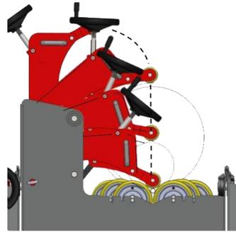
**Tubulus 24** est un système de positionnement pour tubes qui permet et facilite la rotation de pièces même avec un centre de gravité déporté, sans nécessité d'un contre-poids, comme l'accouplement de tubes et coudes.
