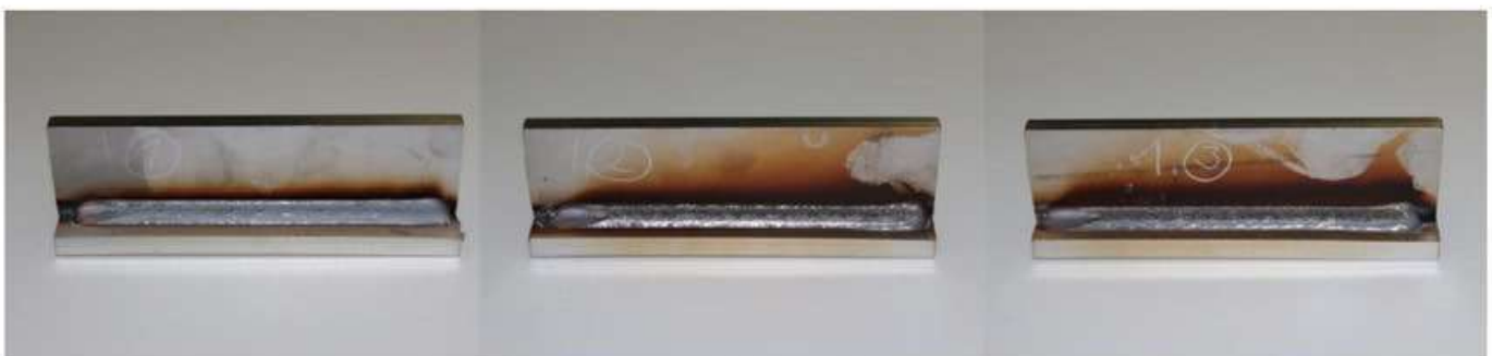
Figure 7 : Comparaison de l'aspect des cordons et des colorations thermiques, tôle t = 10 mm, DV = 13 m/min ; à gauche forceArc puls, au centre forceArc, à droite arc pulsé
