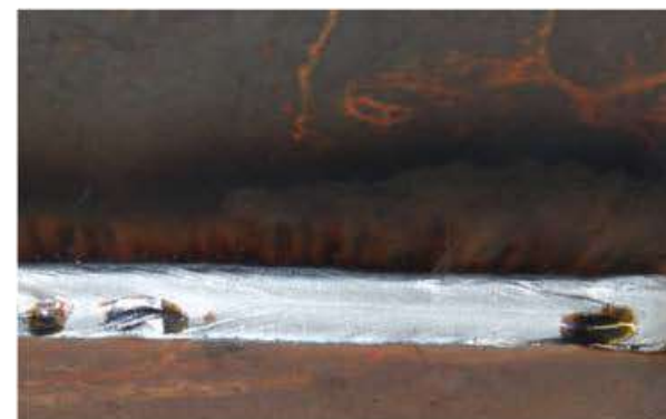
S355, t=10 mm, assemblage en T, soudure en angle sans préparation du cordon, I = 316 A, U = 28,8 V, dévidage = 10,5 m/min, Vs = 50 cm/min
