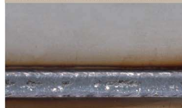
1.4301(304), t=10 mm, assemblage en T, soudure en angle sans préparation du cordon, I = 324 A, U = 25,6 V, dévidage = 11,5 m/min, Vs = 35 cm/min
