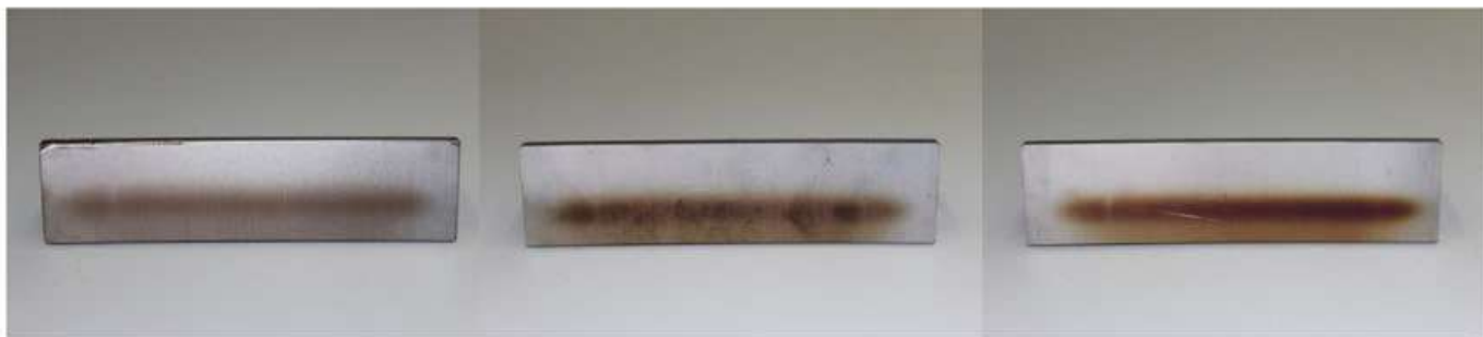
Figure 8 : Comparatif des colorations thermiques sur la face inférieure ; à gauche forceArc puls, au centre forceArc, à droite arc pulsé
