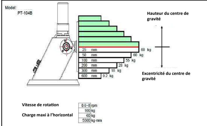
Positionneur avec affichage numérique composé d'une structure robuste avec vitesse de rotation variable
