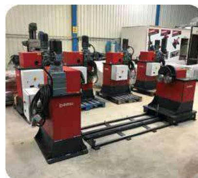
Ce positionneur permet la rotation de châssis et autres constructions métalliques avec axe de rotation variable en hauteur.
