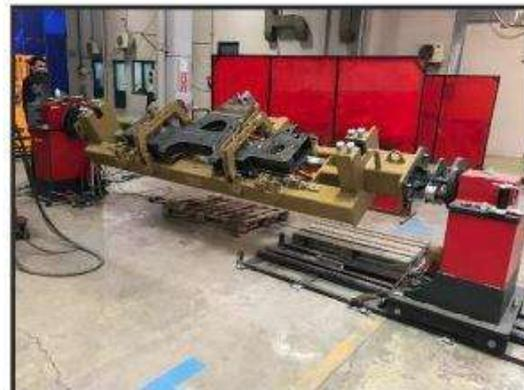
**Ce positionneur permet la rotation de châssis et autres constructions métalliques**
