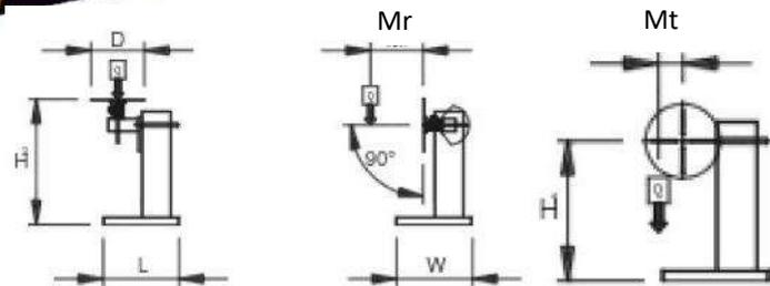
Positionneur à table rotative capacité 100 kg. Rotation avec moteur à courant continu.
