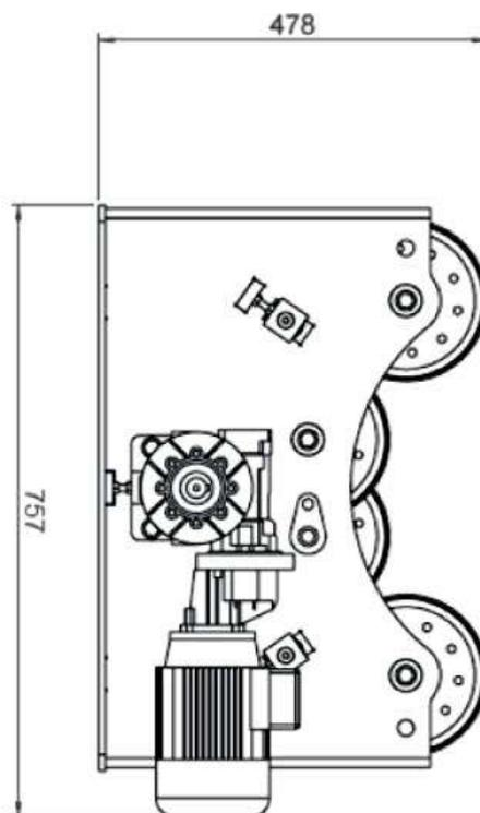
Les vireurs ECO-BCR sont une solution de qualité et économique pour les soudures circulaires de pièces cylindriques dont le diamètre n'est pas trop variable.
