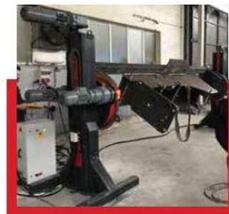
**Construction robuste et couple de rotation important permettant la rotation de pièces de 1 500 KG**
