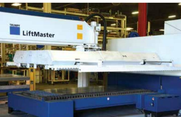
Faites fonctionner votre chargeur/déchargeur de tôles LiftMaster via SigmaNEST
