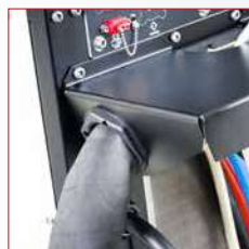
Décharge de traction pour faisceau intermédiaire
