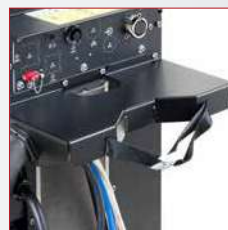
Support de bouteille de gaz de protection pour une bouteille de gaz
