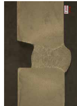
Épaisseur de tôle 10 mm, chanfrein d'un côté 15 degrés, jour 4 mm
