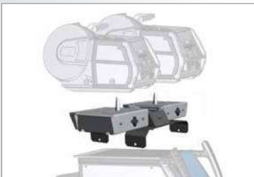
Installation de deux dévidoirs
