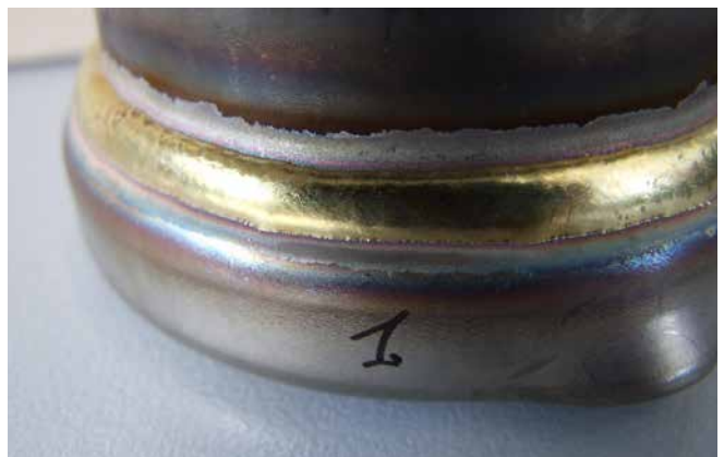
Brasage de tôles hautement alliées (CrNi)
