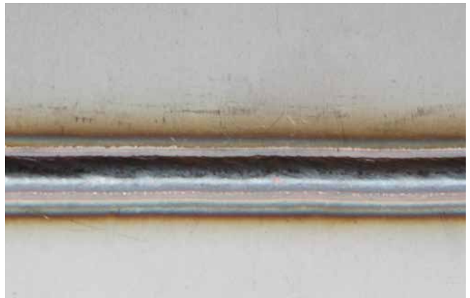
Soudage de tôles hautement alliées
