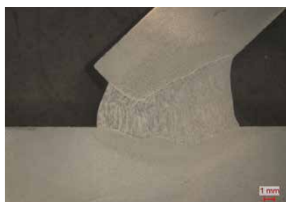
Épaisseur de tôle d'âme 10 mm, angle d'ouverture 35°
