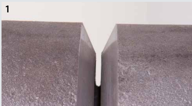
Préparation du cordon d'un soudage de racine sur tube, angle d'ouverture de 60° avec jour de 3 mm
