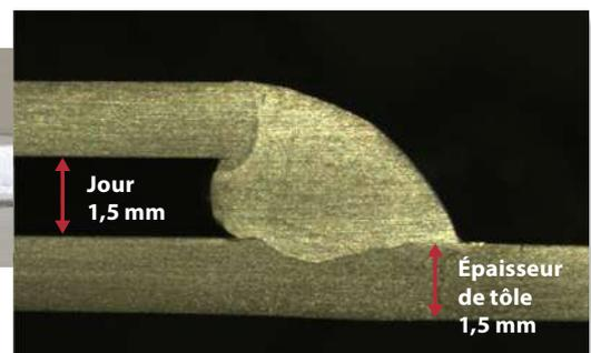
Soudure à recouvrement :
