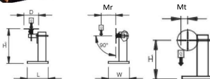
Positionneur à table rotative capacité 100 kg. Rotation avec moteur à courant continu.
